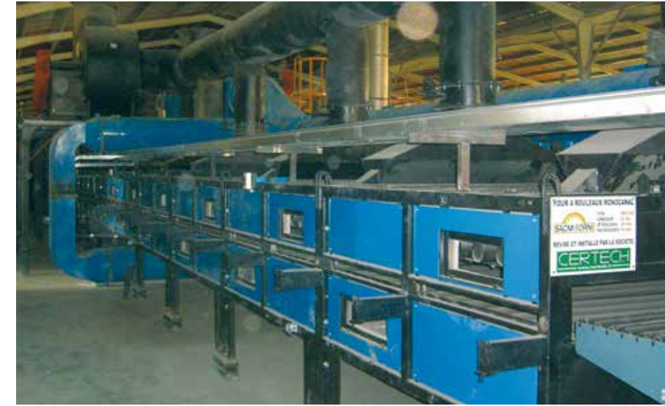
Forno monocanale usato e revisionato durante la fase di montaggio. Second-hand regenerated single-channel kiln during assembly. Horno monocanal usado y revisado durante el montaje. Four monocanal usagé et révisé durant la phase de montage.
