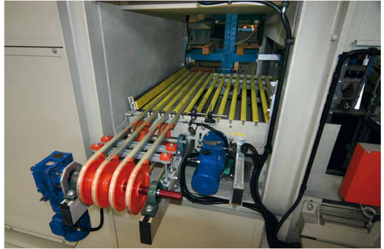
Dettaglio rulliera di scarico essiccatoio verticale, revisionato. Detail of unloading roller conveyor of a regenerated vertical drier. Detalle de rodillera de descarga de un secadero vertical , revisado. Détaille table à rouleaux de déchargements séchoir vertical, révisé.
