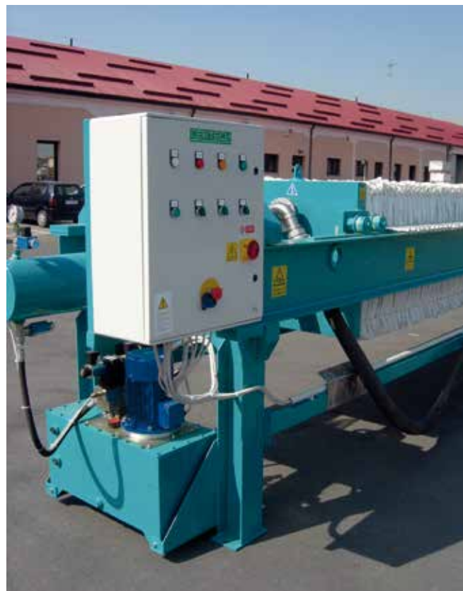
Dettaglio quadro elettrico e centralina idraulica. Detail of electric board and hydraulic station. Detalle de cuadro electrico y unidad hidraulica. Détail tableau électrique et centrale hydraulique.
