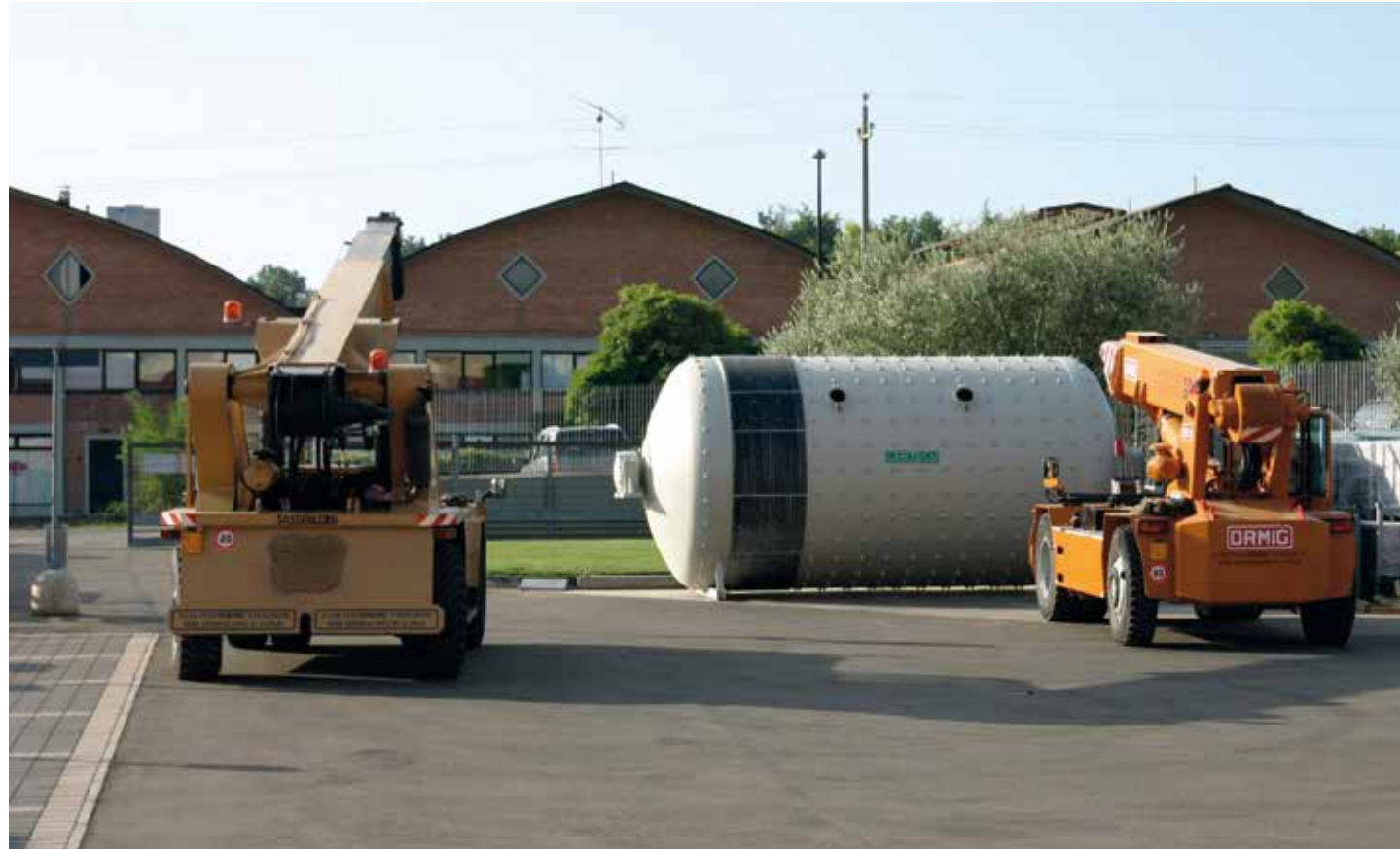
Molino ICF con capacità di 38.000 litri revisionato. Regenerated ICF mill with capacity of 38.000 Lt. Molino ICF con capacidad de 38,000 litros revisado. Broyeur ICF d'une capacité de 38.000 litres révisés.
