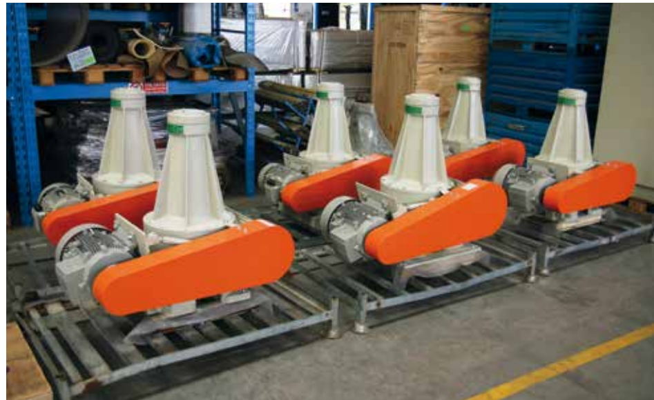
Nr. 06 agitatori per barbotina usati e revisionati. Nr.06 used and regenerated stirrers for slip. Nr. 06 agitadores para barbotina usados y revisados. Nr. 06 agitateurs pour barbotine d'occasion et révisé.
