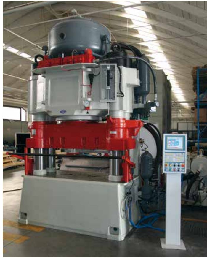
Pressa da 1400 ton revisionata, in fase di collaudo presso la nostra sede. Regenerated press of 1400 Ton, in testing phase by our factory. Prensa de 1400 ton revisada , en fase de aceptacion en nuestro taller. Presse de 1400 tonne révisé, en phase d'épreuve auprès de notre siège.
