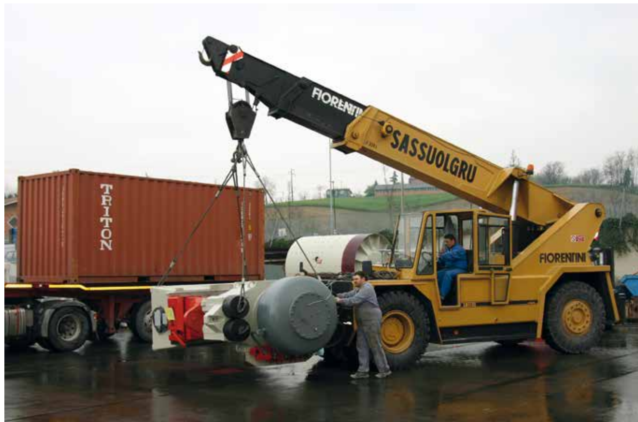
Pressa da 1400 ton revisionata, durante la fase di carico. Regenerated press of 1400 Ton, during the loading phase. Prensa de 1400 ton revisada , durante la fase de carga. Presse de 1400 tonne révisé, pendant la phase de chargement.
