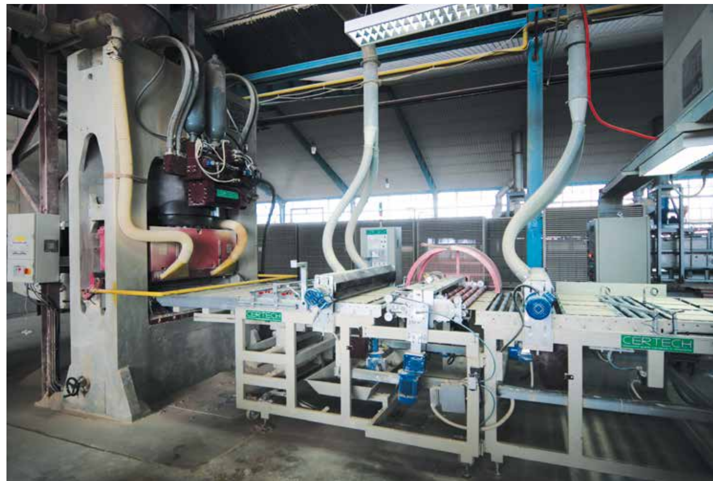
Pressa da 1.200 ton e raccogliatore pressa usati e revisionati. Second-hand regenerated 1,200 ton press and press collector unit. Prensa de 1.200 toneladas y regojedor prensa usados y revisados. Presse de 1.200 ton et ramasseur presse usagés et révisés.
