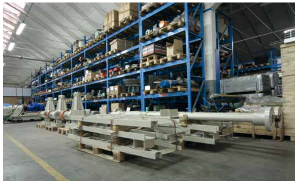
Alberi e pale nuovi da montare su agitatori revisionati. New shafts and blades to assemble on the regenerated stirrers. Ejes y aspas nuevas para montar sobre agitadores revisados. Arbres et nouvelles pales neufs à monter sur des agitateurs révisés.
