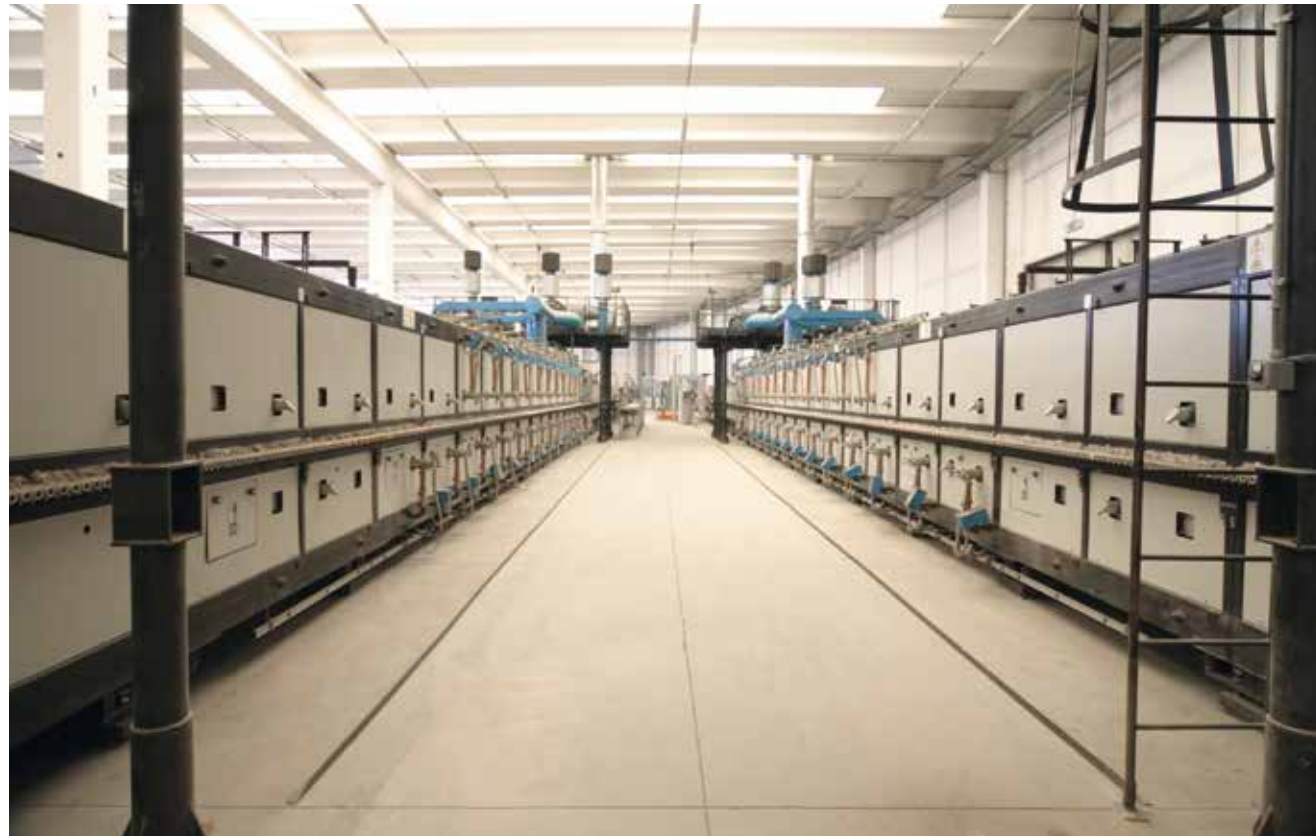
Nr. 02 forni a rulli monostrato prima dello smontaggio. Nr.02 single-layer roller kiln before the disassembling. 02 Hornos a rodillos monocanal antes del desmontaje. Nr.02 fours aux roulements monocouche avant le démontage.
