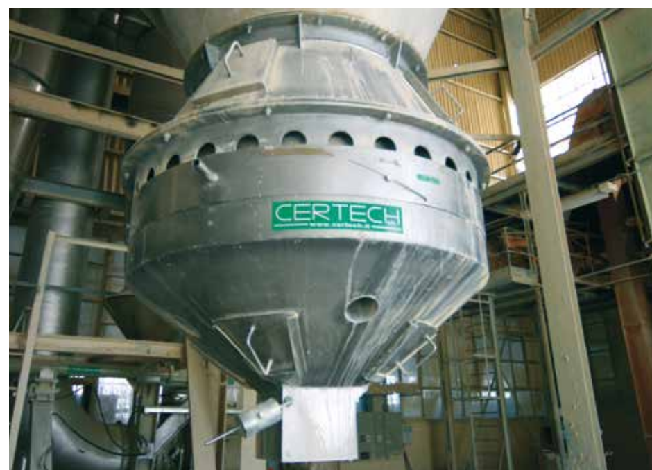
Raffreddatore standard per polvere atomizzata da installare sotto l'atomizzatore. Standard cooler for spray-dried powder to be installed under the spray drier. Enfriador estándar para polvo atomizado a instalar abajo del atomizador. Refroidisseur standard pour poudre atomisée à installer sous l'atomiseur.
