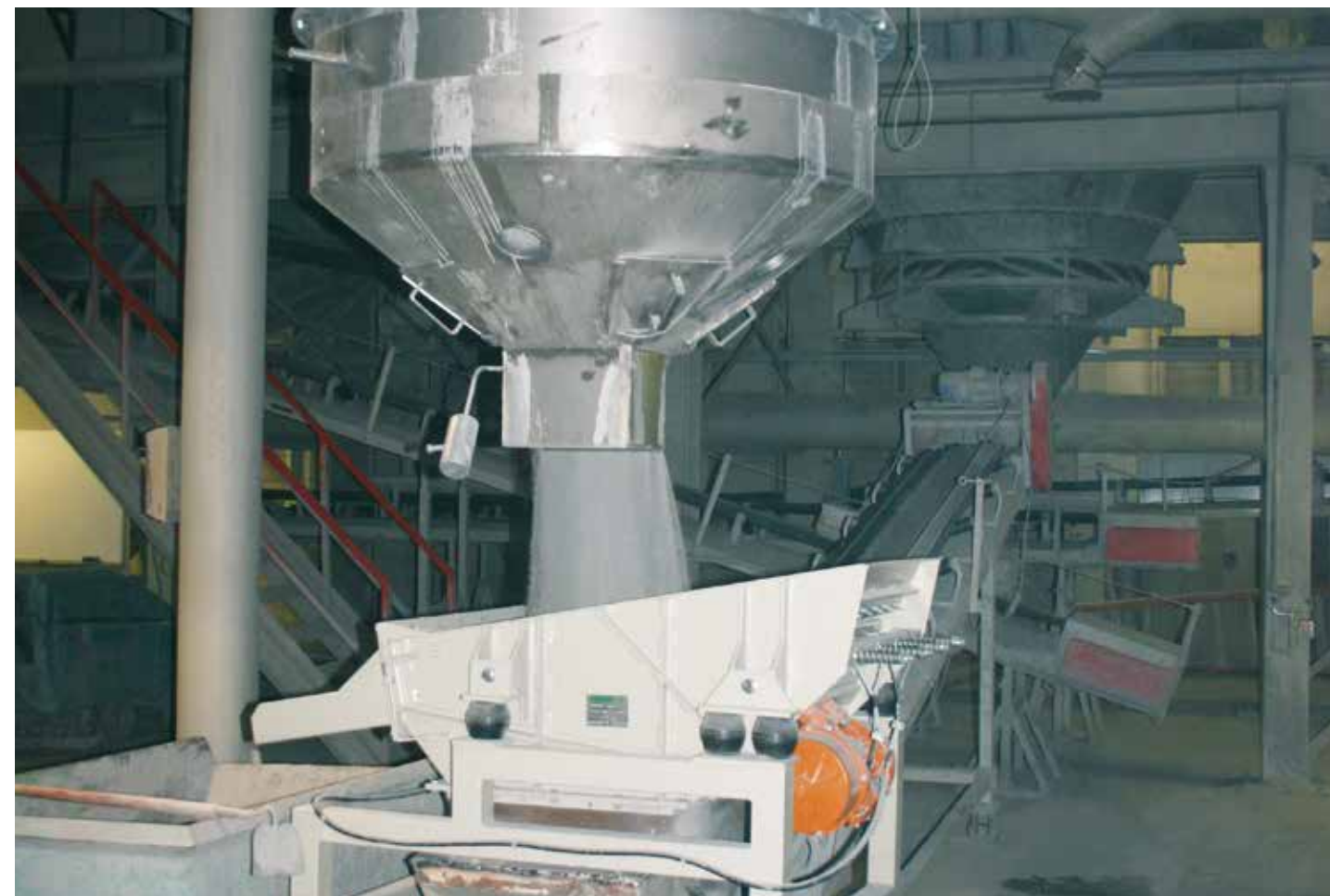
Dettaglio di raffreddatore per polvere atomizzata e di nostro setaccio SET 700. Detail of a cooler for spray dried powder and of our SET 700 screen. Detalle de enfriador para polvo atomizado y de nuestro tamiz SET 700. Détail d'un refroidisseur pour poudre atomisée et de notre tamis SET 700.
