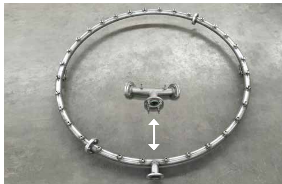
Corona di spruzzatura per atomizzatori con possibilità di averla con raccordo di ingresso intercambiabile e flangiata in due metà per facilitarne la pulizia. Spraying crown for spray driers with possibility of made it with interchangeable entry connection and flanged in two halves to ease its cleaning. Corona de pulverización para atomizadores con posibilidad de tenerla con conexión de entrada intercambiabile y con brida en dos mitades para facilitar su limpieza. Couronne de pulverisation pour atomiseurs avec possibilité de l'avoir avec connexion d'entrée interchangeable et avec bride en deux moitiés pour en faciliter le nettoyage.
