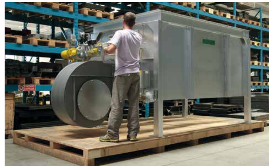
Bruciatore in vena d'aria di grosse dimensioni in fase di controllo. Duct burner of big dimensions in checking phase. Quemador en vena de aire de grandes dimensiones en fase de control. Brûleur en veine d'air de grandes dimensions en phase de contrôle.
