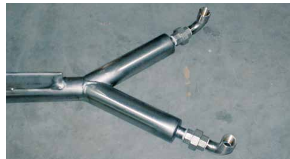
Dettaglio di lance per atomizzatore con attacco ugelli orientabili e tubo coibentato anti condensa. Detail of lances for spray dryer with adjustable nozzles connection and insulated anti-condensation pipe. Detalle de lanzas para atomizador con empalme de boquillas orientables y tubo aislado anticondensación. Détail de lances pour atomiseur avec raccord pour buses orientables et tuyau isolé anti-condensation.
