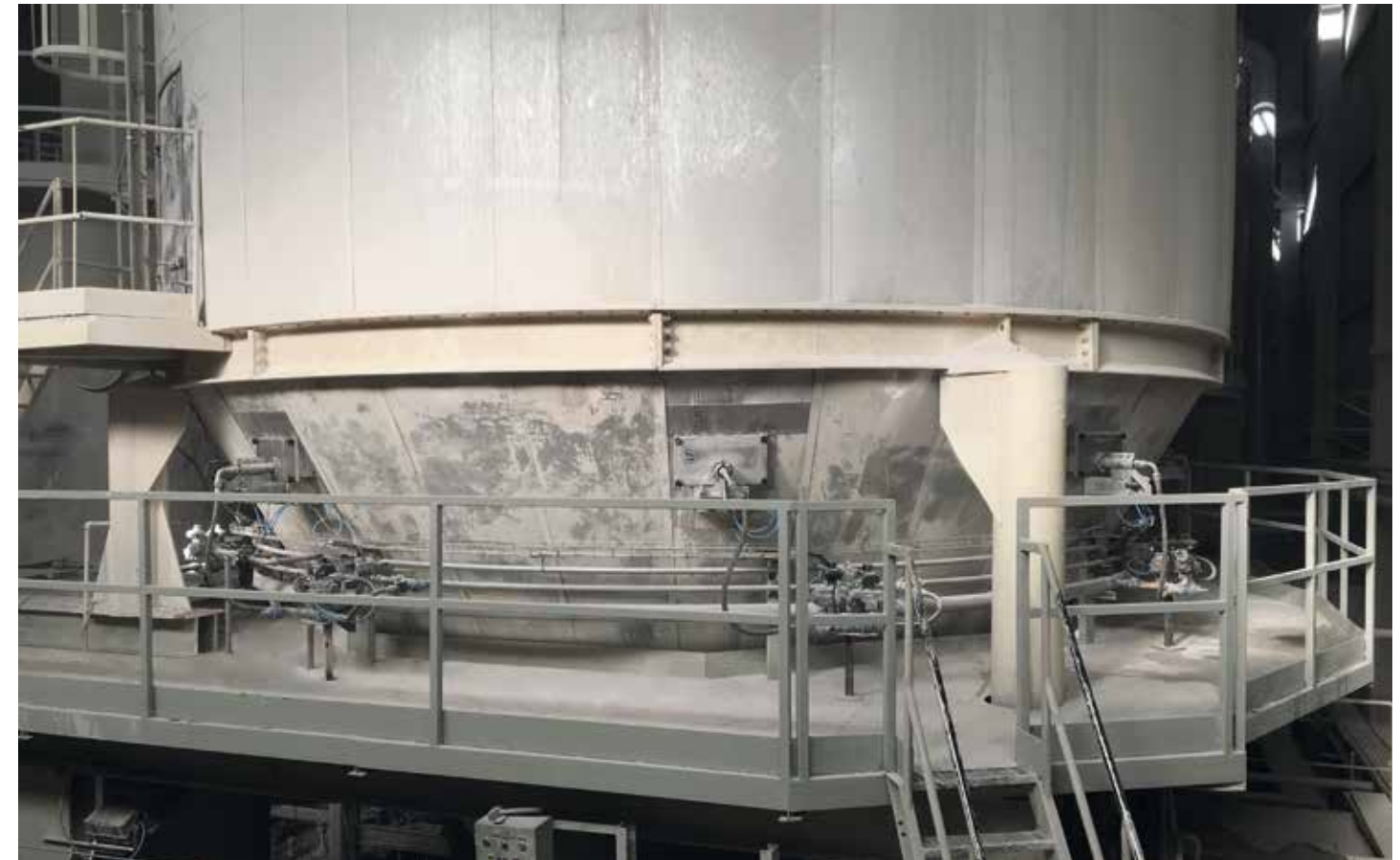
Trasformazione atomizzatore a corona, con serie di lance di spruzzatura dotate di sistema di scuotimento automatico e sistema di lavaggio automatico. Transformation of the crown spray drier, with a set of spraying lances equipped with automatic shaking system and automatic washing system. Transformación atomizador de corona, con serie de lanzas de pulverización dotadas de sistema de sacudimiento automático y sistema de lavado automático. Transformation atomiseur à couronne, avec série de lances de pulvérisation dotées de système de secousses automatique et système de lavage automatique.
