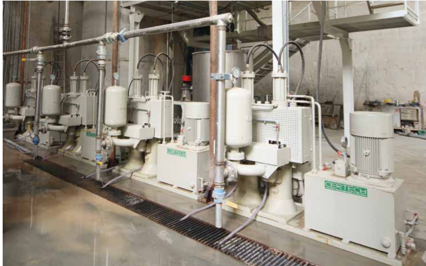
Pompe a pistoni per alimentazione atomizzatore. Piston pumps for the spray drier feeding. Bombas de pistones para alimentación atomizador. Pompes à pistons pour alimentation atomiseur.
