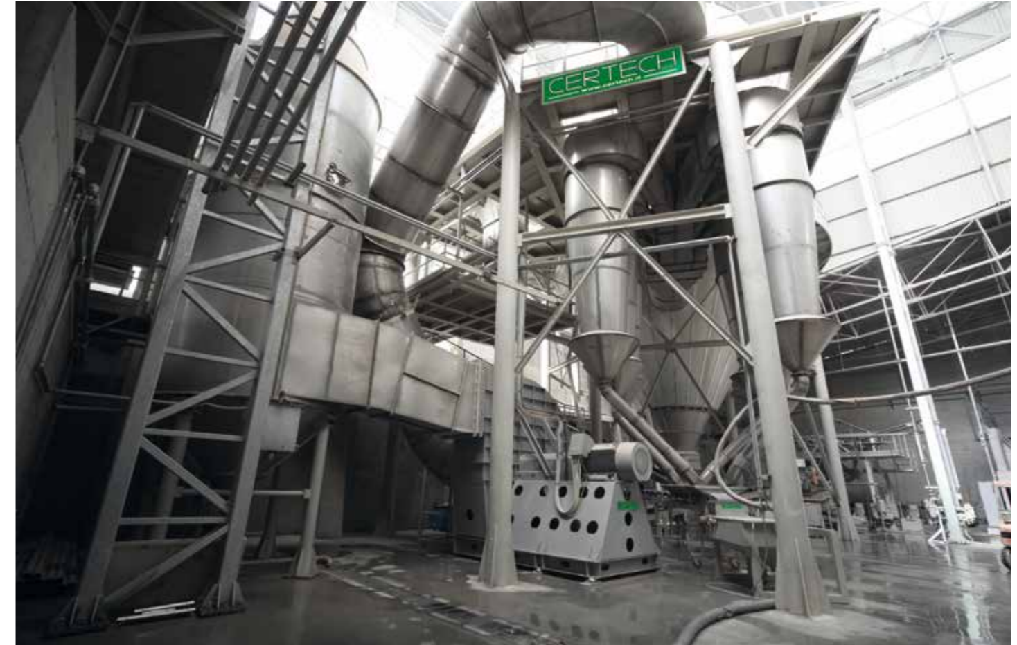
Atomizzatore tipo CSD 20.000 con torre di abbattimento ad umido. Spray drier type CSD 20.000 with wet scrubber tower. Atomizador tipo CSD 20.000 con torre de abatimiento de húmedo. Atomiseur type CSD 20.000 avec tour d'abatage par voie humide.
