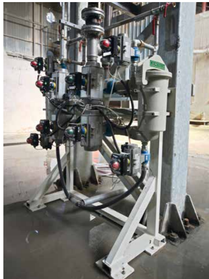
Pompe a pistoni per alimentazione atomizzatore. Piston pumps for the spray drier feeding. Bombas de pistones para alimentación atomizador. Pompes à pistons pour alimentation atomiseur.
