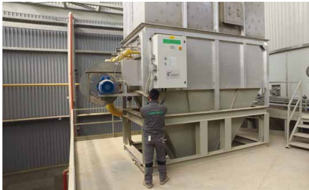
Bruciatore installato su atomizzatore CSD 18.000. Burner installed on CSD 18.000 spray drier. Quemador instalado en atomizador CSD 18.000. Brûleur installé sur atomiseur CSD 18.000.
