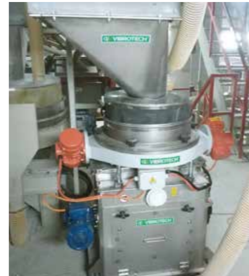
■ Vagliatura e deferrizzazione atomizzata. ■ Atomized sieving and iron removal. ■ Cribado y deferrización atomizado. ■ Tamisage et déferrisation atomisé.
