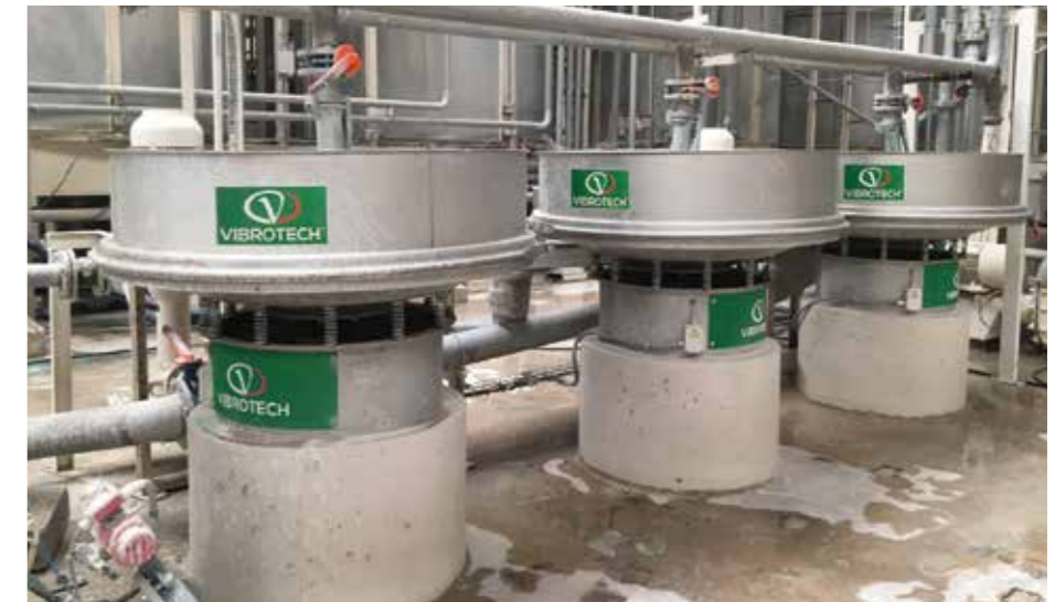
■ Vagliatura barbotina. ■ Slurry sieving. ■ Cribado barbotina. ■ Tamisage barbotine.
