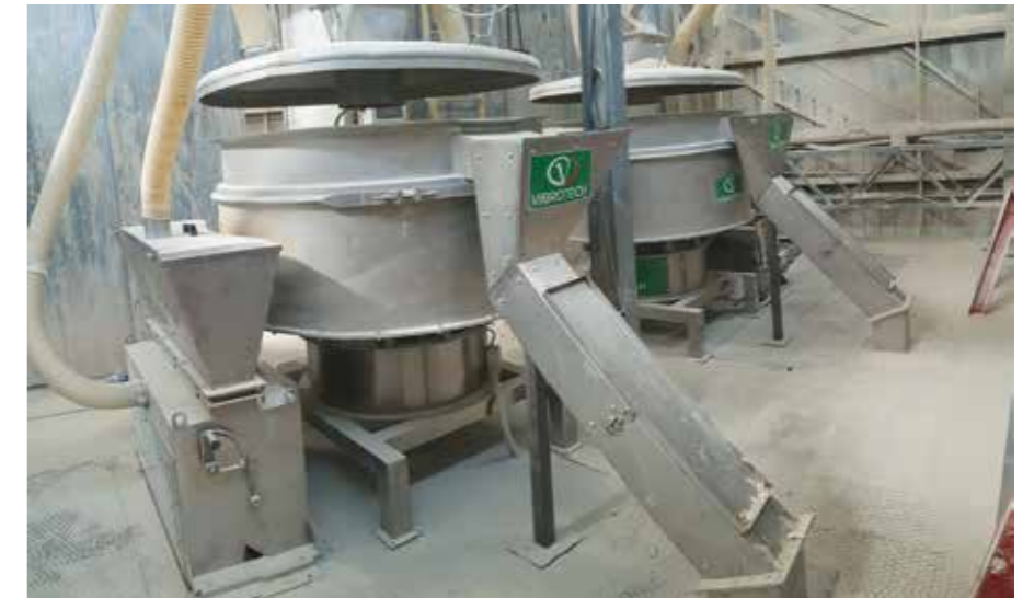
■ Vagliatura e deferrizzazione atomizzata. ■ Atomized sieving and iron removal. ■ Cribado y deferrización atomizado. ■ Tamisage et déferrisation atomisé.
