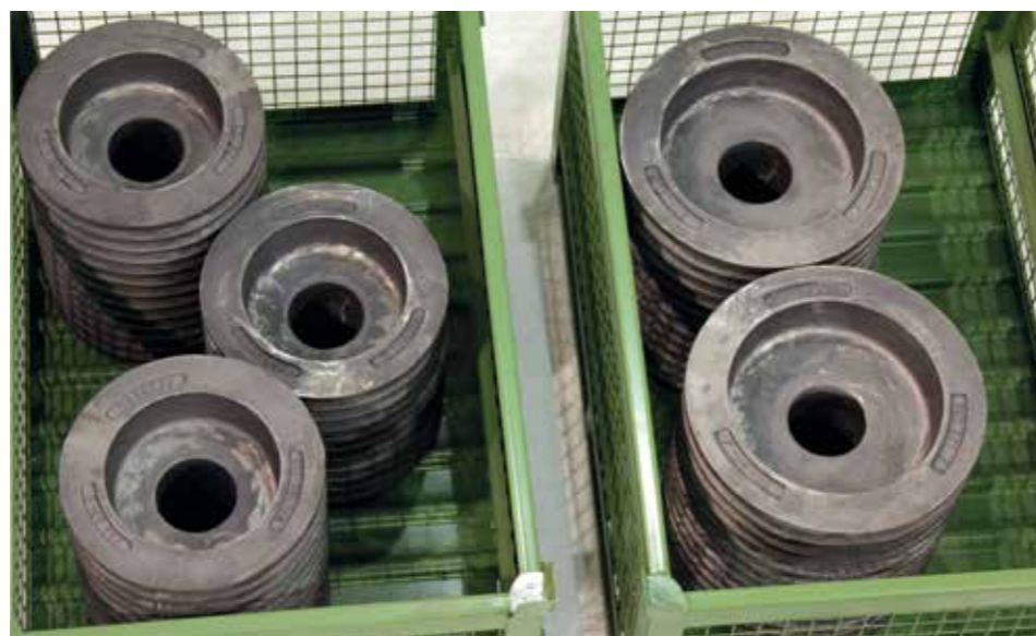
Puleggie grezze ancora da lavorare. Rough pulleys, still to be worked. Poleas antes de maquinar. Poulies brutes à travailler.
