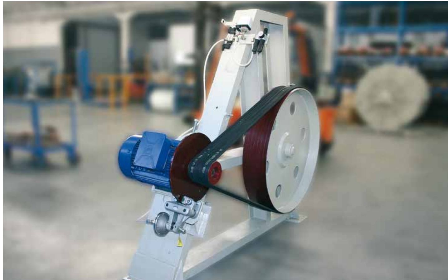
Basamento e motorizzazione per mulino da 3.000 litri. Base assembly and motorization unit for 3,000 litre mills. Base y motorización para molino de 3.000 litros. Base et motorisation pour moulin de 3.000 litres.
