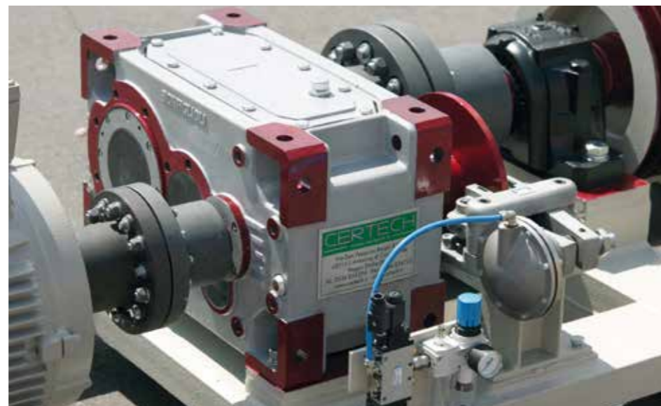
Motorizzazione tipo MRC 05. Dettaglio riduttore e gruppo frenante. MRC 05 motorization unit. Detail of reduction gear and braking group Motorizacion tipo MRC 05. Detalle reductor y grupo freno. Motorisation type MRC 05. Détail réducteur et groupe de freinage.
