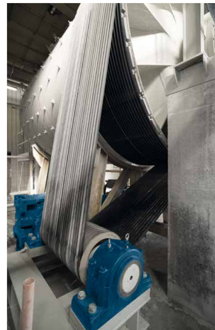
Gruppo puleggia e zona cinghie con gole composta da pannelli in speciale polimero. Pulley group and belt zone with grooves composed by special polymer panels. Grupo polea y zona correas con ranuras compuesta por paneles en polímero especial. Groupe poulie et zone courroies avec gorges composée par panneaux en polymère spéciale.
