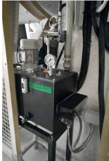
Dettaglio centralina idraulica di lubrificazione cuscinetti. Detail of hydraulic station for bearings lubrication. Detalle central hidráulica para lubricación rodamientos. Détail centrale hydraulique de lubrification coussinets.
