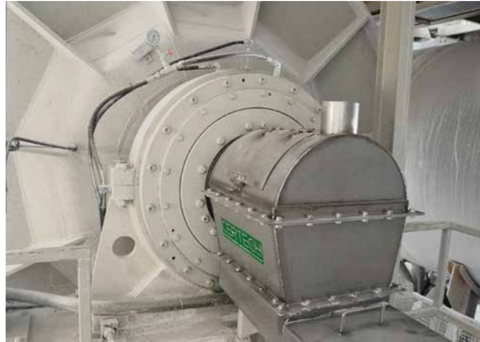
Supporto mulino con lubrificazione forzata per il cuscinetto. Mill's support with forced lubrication for the bearing. Soporte molino con lubricación forzada para el rodamiento. Soutien broyeur avec lubrification forcée pour le coussinet.
