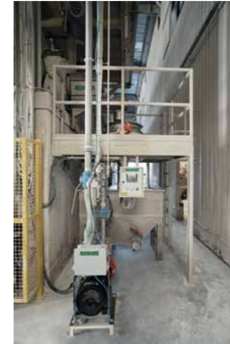
Pompa centrifuga di trasferimento barbotina da 1° a 2° o 3° modulo. Centrifugal pump for the slip transfer from 1 st to 2 nd or 3 rd module. Bomba centrifuga para la transferencia de la barbotina desde 1er hasta 2° o 3er módulo. Pompe centrifuge pour le transfert de la barbotine du 1 er au 2 nd ou 3 ème module.
