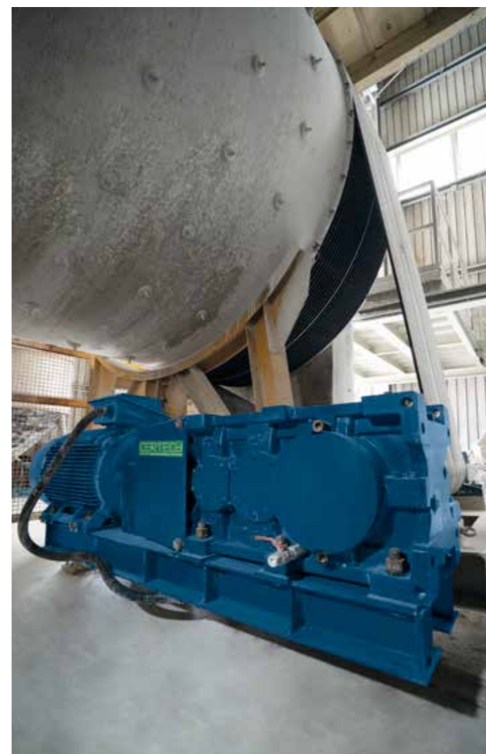
Motorizzazione con riduttore ortogonale installato su primo modulo. Driving unit with orthogonal reduction gear installed on first module. Motorización con reductor orthogonal instalada en primer módulo. Motorisation avec réducteur orthogonale installée sur premier module.
