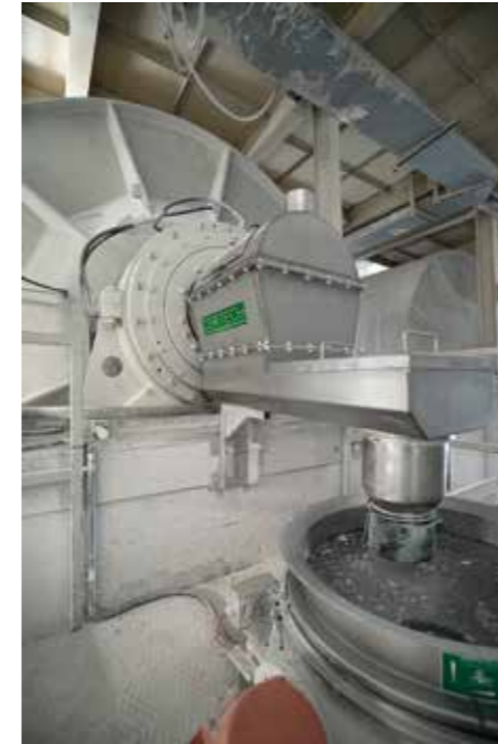
Dettaglio scarico barbotina primo modulo. Detail of slip unloading of first module. Detalle descarga barbotina primer módulo. Détail déchargement barbotine premier module.
