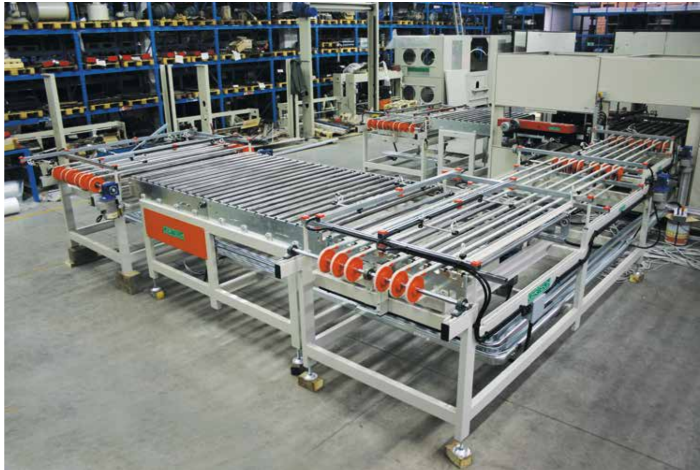
Sistema di trasporto, carico scarico essiccatoio per formati 900mm x 1200mm. System for transport, drier loading/unloading for 900 mm x 1200 mm sizes. Sistema de transporte, carga y descarga de secadero para formatos 900mm x 1200mm. Système de transport, chargement, déchargement séchoir pour formats 900 mm x 1200 mm
