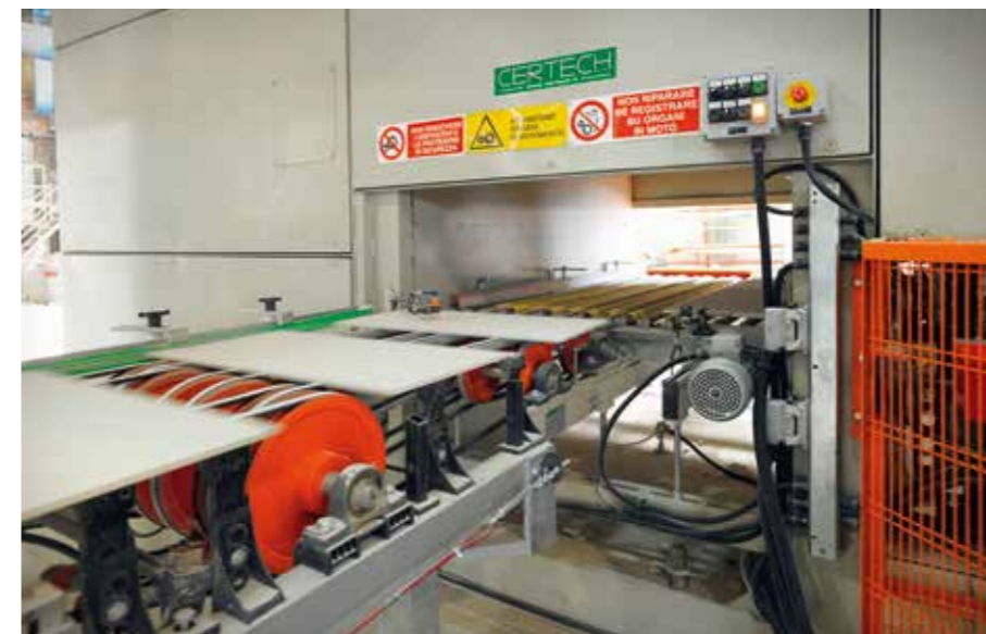
Dettaglio rulliera di scarico. Detail of the unloading roller way. Detalle rodillera de descarga. Détail chemin à rouleaux de déchargement.
