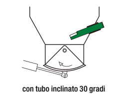
con tubo inclinato 30 gradi saldato alla tramoggia with 30 degrees inclined mounting sleeve, welded to the bin wall con tubo inclinado 30 grados soldado a la tolva avec tuyau incliné 30 degrés soudé à la trémie
