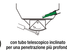
con tubo inclinato 30 gradi saldato alla tramoggia with 30 degrees inclined mounting sleeve, welded to the bin wall con tubo inclinado 30 grados soldado a la tolva avec tuyau incliné 30 degrés soudé à la trémie
