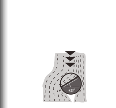
corretta inclinazione assiale della superficie di lettura della sonda rispetto al passaggio del materiale correct inclination of the probe's sensing plate with regard to the material's ow correcta inclinación axial de la superficie de lectura de la sonda respecto al pasaje del material correcte inclination axiale de la sonde par rapport au passage du matériel
