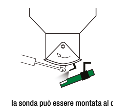
en cas d'installation horizontale et perpendiculaire au poids du matériel, prévoir une barrière métallique à protection de la sonde the probe can be mounted under the bin's extraction gate (the picture shows also the optional compressed air blower nozzle, to ensure automatic cleaning of the probe sensing face)
