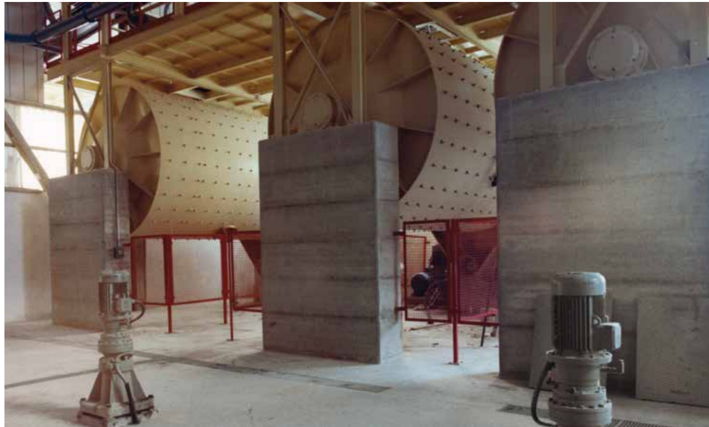
Batteria di mulini discontinui con fondi pari. Set of discontinuous mills with flat bottom heads. Bateria de molinos discontinuos con fondos pares. Batterie de moulins discontinus avec fonds plats.
