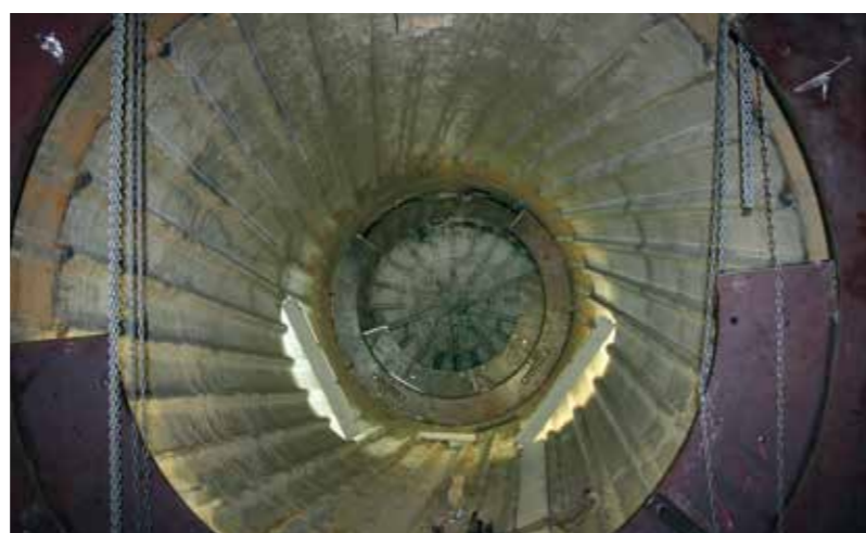
Assemblaggio di n. 2 anelli in acciaio all'interno del mulino. Assembly of the 2 steel ring inside the mill. Ensamblaje de nr. 2 anillos en acero en el interior del molino. Assemblage de nr. 2 anneaux en acier à l'intérieur du broyeur.
