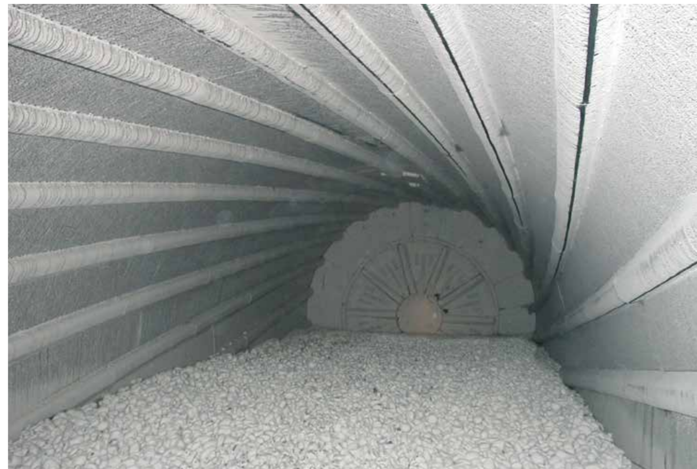
Vista interna della prima camera di un mulino continuo classificante con capacità di 80.000 litri. Internal view of the first chamber of a continuous sorting mill with a capacity of 80,000 litres. Vista interna de la primera cámara de un molino continuo clasificador con capacidad de 80.000 litros. Vue interne de la première chambre d'un moulin continu de classification doté d'une capacité de 80 000 litres.
