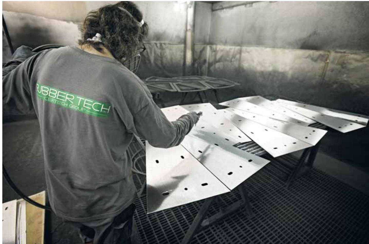
Applicazione prodotto aggrappante sui supporti metallici. Application of gripping agent on metal supports. Aplicación del producto de fijación a los soportes metálicos. Application produit d'accrochage sur les supports métalliques.
