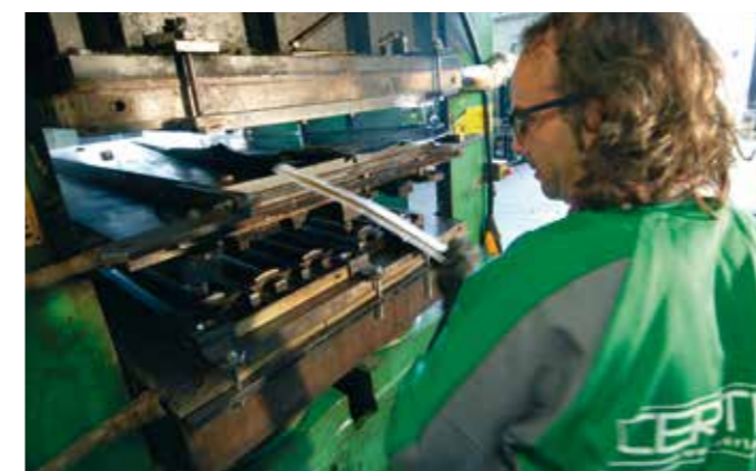
Pressa a due piani in fase di apertura. Two-level press during the opening stage. Prensa de dos planos en fase de apertura. Presse à deux étages en phase d'ouverture.
