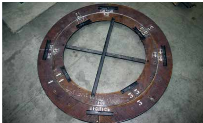
Pre-assemblaggio dell'anello in acciaio presso la nostra sede. Pre-assembly of the steel ring at our firm. Preensamblaje del anillo en acero en nuestra sede. Préassemblage de l'anneau en acier à notre établissement.
