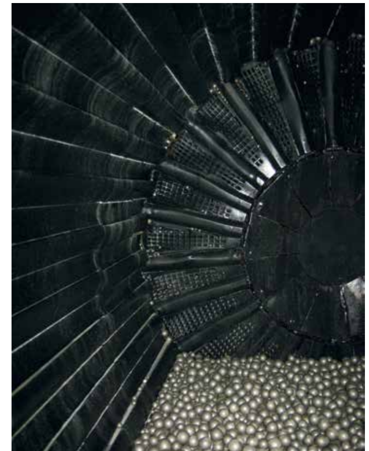
Vista interna mulino. Internal view of a mill. Vista interna del molino. Vue interne du broyeur.
