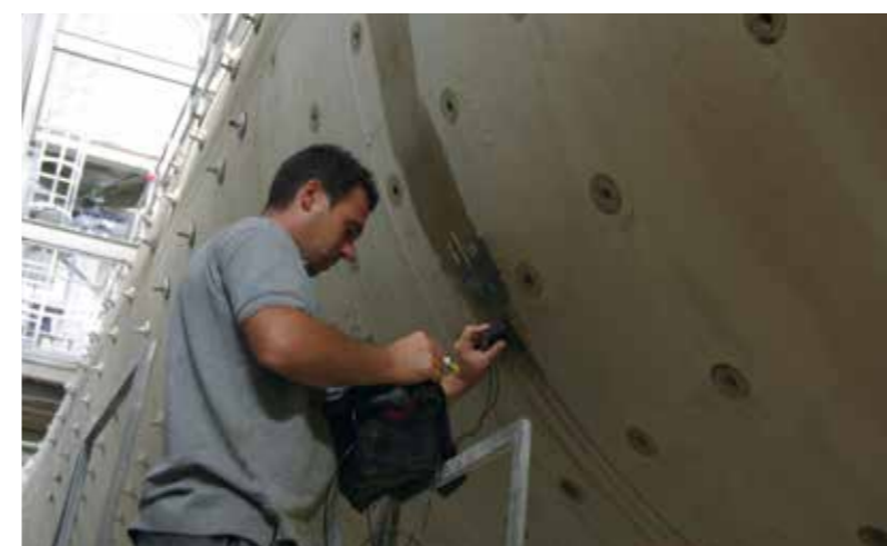
Controllo strutturale del cilindro del mulino con ultrasuoni. Structural testing of the mill cylinder with ultrasound. Control estructural del cilindro del molino con ultrasonidos. Contrôle de la structure du cylindre du broyeur par le biais d'ultrasons.
