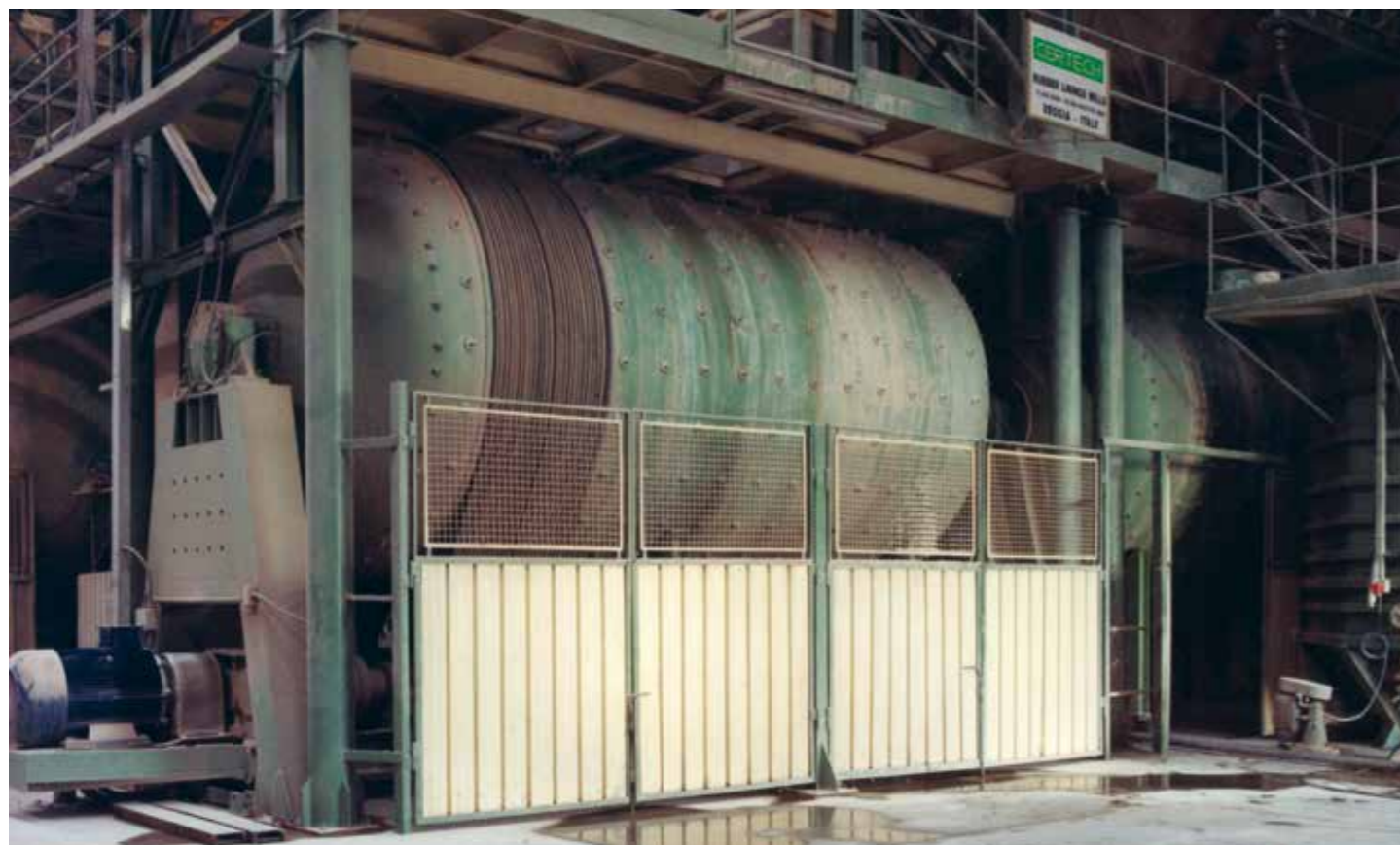
Batteria di mulini discontinui con fondi bombati. Set of discontinuous mills with rounded bottom heads. Bateria de molinos discontinuos con fondos abombados. Batterie de moulins discontinus avec fonds bombés.
